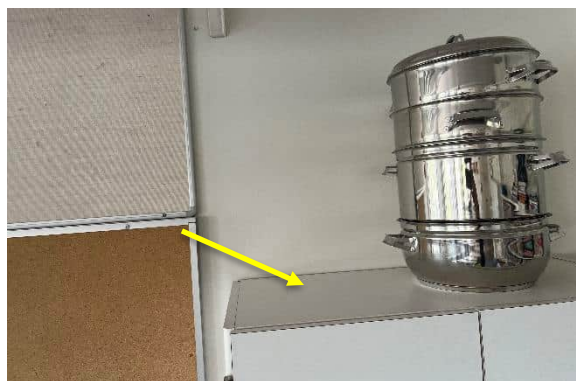
Kuva 6 Tekstiilityöluokan kuitukeräyspiste 2.3 etuosan korkean kaapin päällä: 0,57 kuitua/cm 2 .
