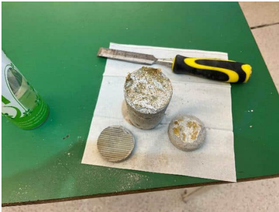
Kuva 6 Rakennearvauksesta RA 17 VP irrotettuja rakennekerroksia
