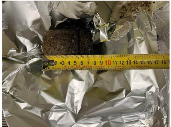
Kuva 5 Rakennearvauksesta RA 13 AP irrotetut rakennekerrokset.
