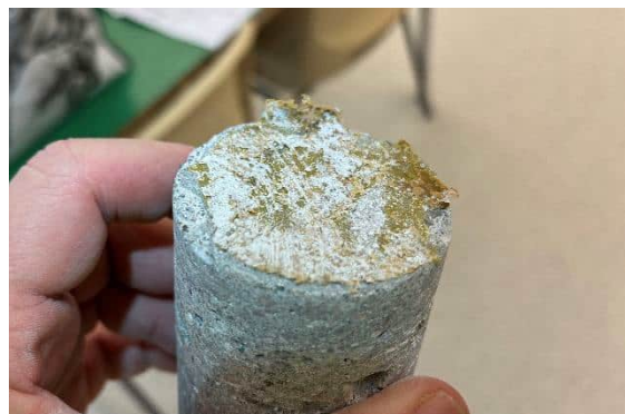
Kuva 27 N27. Luokka 102. Pintavalun alapuolinen liima ja tasoitteet eivät sisällä asbestia.
