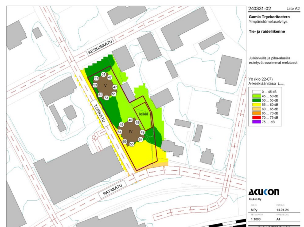
Kuva 32. Ote Gamla Tryckeriteaternin (2024) meluselvityksestä, jossa vasemmanpuoleinen kuva esittää LA_{eq} -arvot päiväaikaan ja ne arvot, joille julkisivut altistuvat. Oikeanpuoleinen kuva esittää LA_{eq} -arvot yöaikaan.
