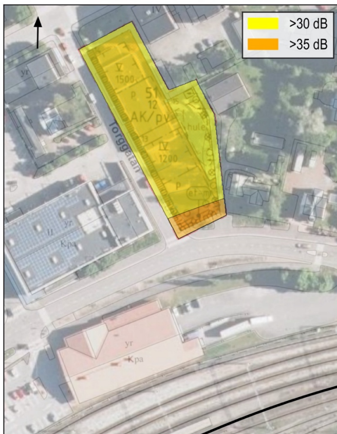
Kuva 1: Mallinnustulokset raideliikenteen aiheuttamasta runkomelusta katutasossa.
