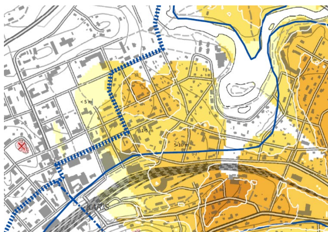
Bild 8. Jordlagret ovanför grundvattennivån varierar i planområdet mellan 1–10 meter enligt Geologiska forskningscentralens utredning 2018. (Utdrag ur Geologisen rakenteen selvitys Raaseporin pohjavesialueilla Björknäs, Ekerö ja Karjaa B 2018)
